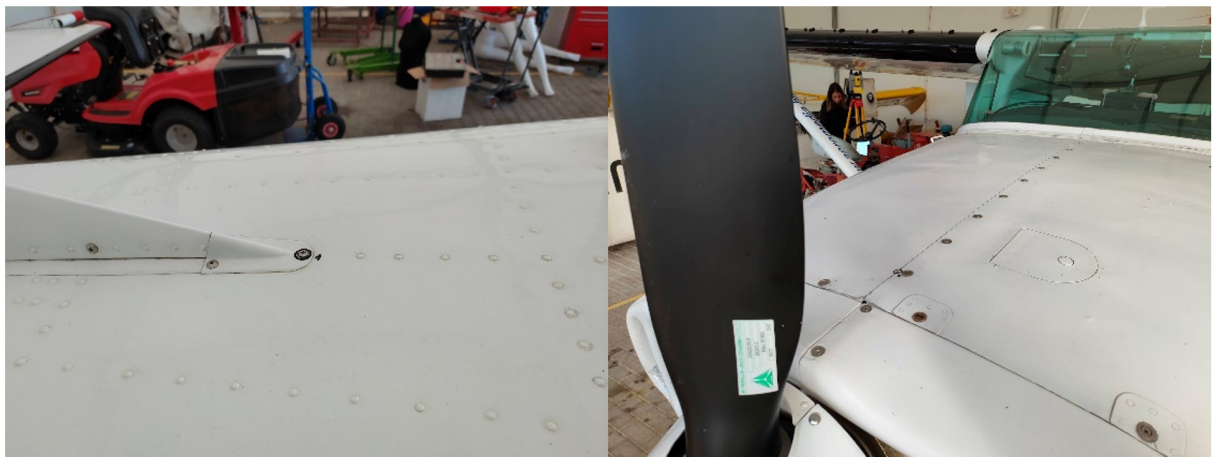
25. ábra Tengely pontok Gép farkánál (1) Légszár mögött (2)
