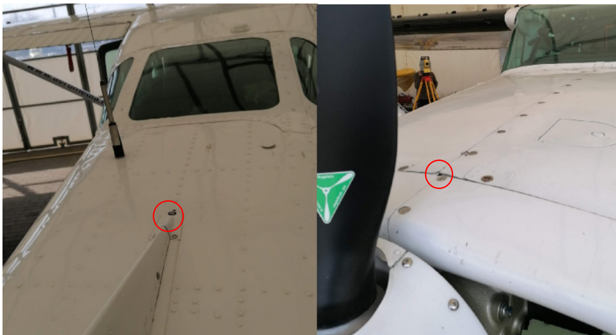
5. ábra Pontok a repülőn, a tengelyvonal végpontjai
