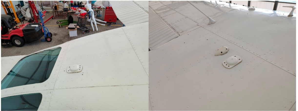
26. ábra GPS antennák: Hátsó ablak mögött tengelytől jobbra (3) Operátor fölött tengelytől jobbra (4)
