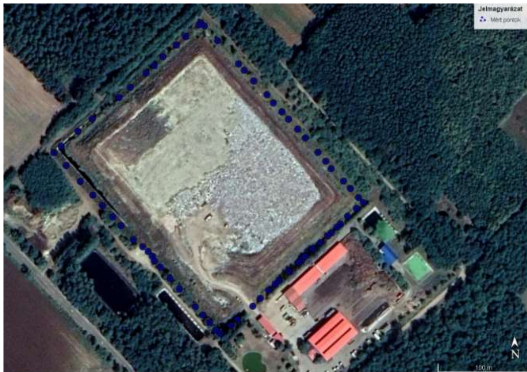
35. ábra: A 70 db mért pont (sötétkék) a koronavonal mentén [saját forrás]
