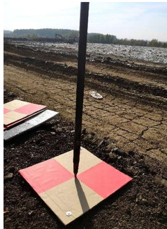
36. ábra: GCP bemérése GPS eszközzel [saját forrás]
