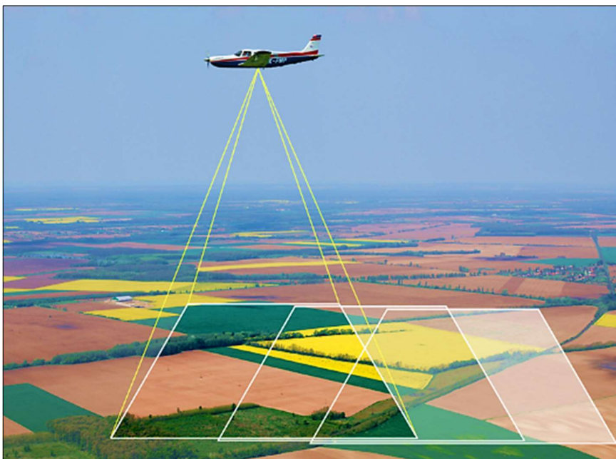
11. ábra: Légi felvételezés merevszárnyú repülőgépre szerelt kamerával [29]
