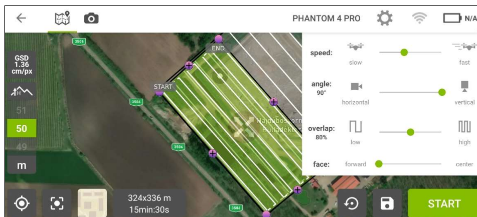
32. ábra: Drón és kamerájának beállítása [saját forrás]
