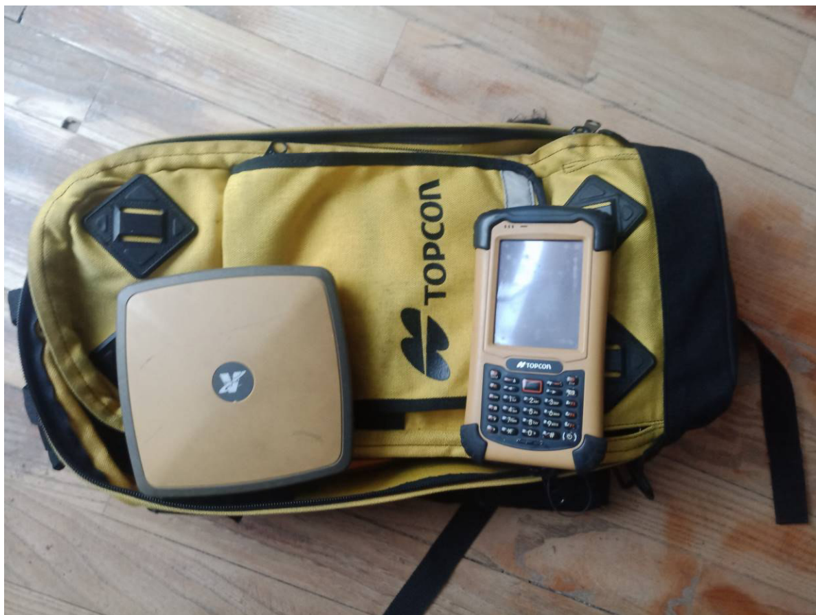
12. ábra. TOPCON HiPer Sr P/N 1000737-01 típusú műszer és kezelője (saját fotó)
