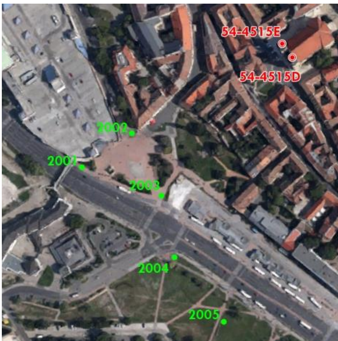
5.5. ábra Szent István Székesegyház körül létesített hálózat pontjai elhelyezkedésének szemléltetése a terepen (forrás: Google térkép)
