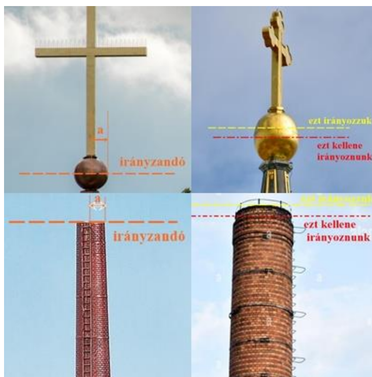
2.3. ábra Magassági irányzás lehetséges megoldásai templomtorny és kémény esetében (forrás: google)
