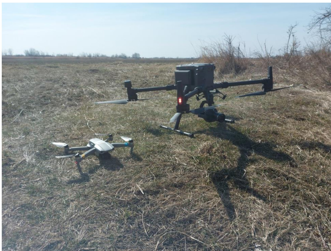
11. ábra: A feladat kivitelezéséhez alkalmazott eszközök (balra a DJI Mavic Air 2, jobbra DJI Matrice 300 RTK)
