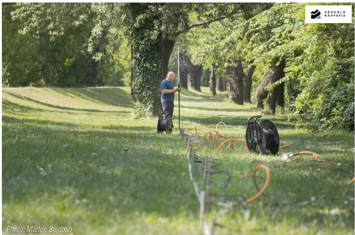
24. ábra: Elektromos ellenállás szelvényezés és a szondázási pontok rögzítése RTK GPS-sel
