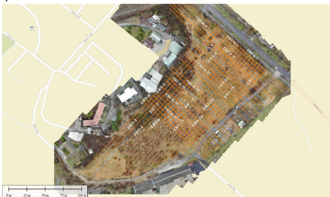
4. ábra: Árajánlat melléklet, üregkutatás geofizikai módszerekkel, elméleti mérési háló szemléltetése nagy felbontású légi felvételen
