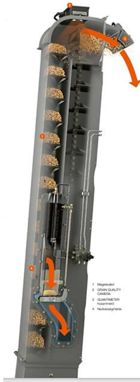
16. ábra: Hozammérési rendszer a magelevátorban
