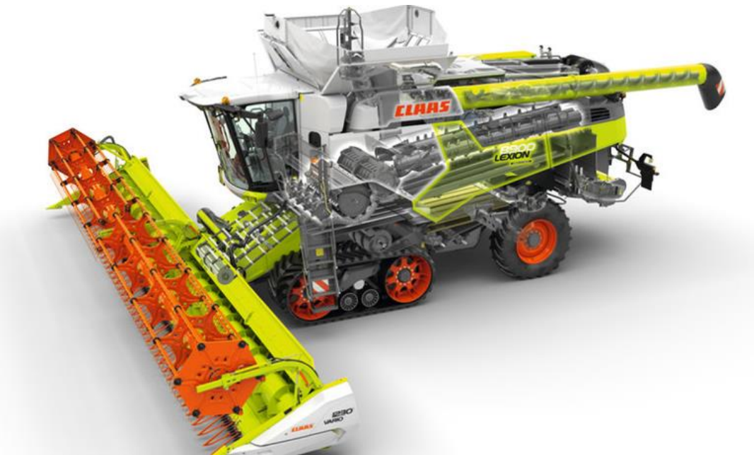
15. ábra: Claas Lexion 7700 MTS kombájn felépítése
