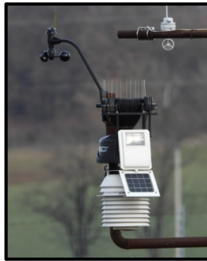
13. ábra: Davis Vantage Pro meteorológiai állomás
