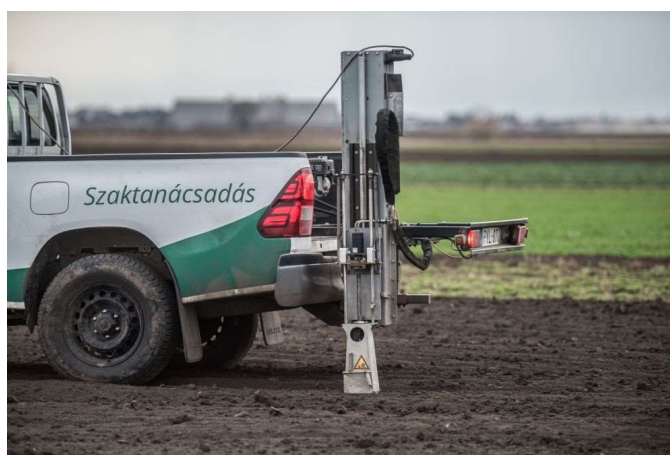
23. ábra: A mintavevő járműre telepíthető N2005 típusú talajmintavevő berendezés (Forrás: https://www.kite.hu/tudastar/fokuszban-a-noveny-igenye/158 )
