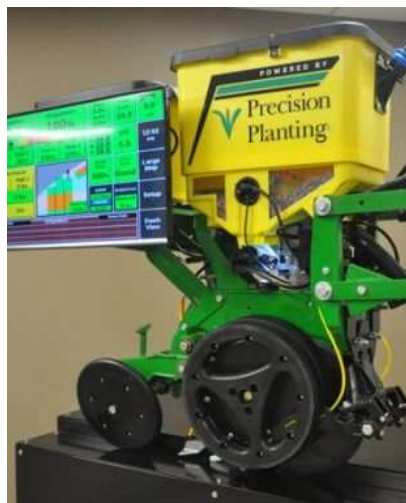
9. ábra: Szakasz vezérelt, differenciált tőszám kijuttatásra alkalmas vetőegység (Forrás: http://nvp2.ca/products/ , 2020.)
