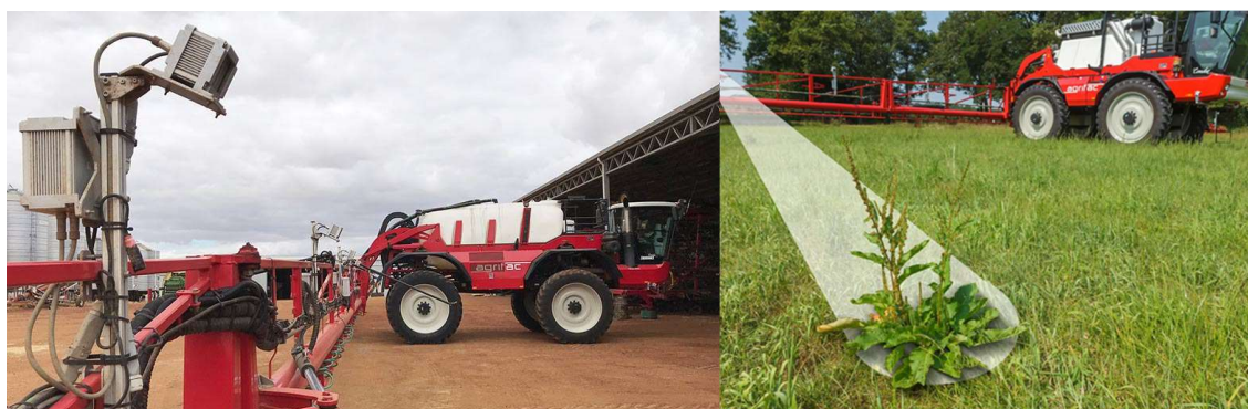
8. ábra: Gyomfelismerő kamerával felszerelt foltkezelésre alkalmas permetező (Forrás: Farmers Weekly magazin, https://www.fwi.co.uk , 2019)
