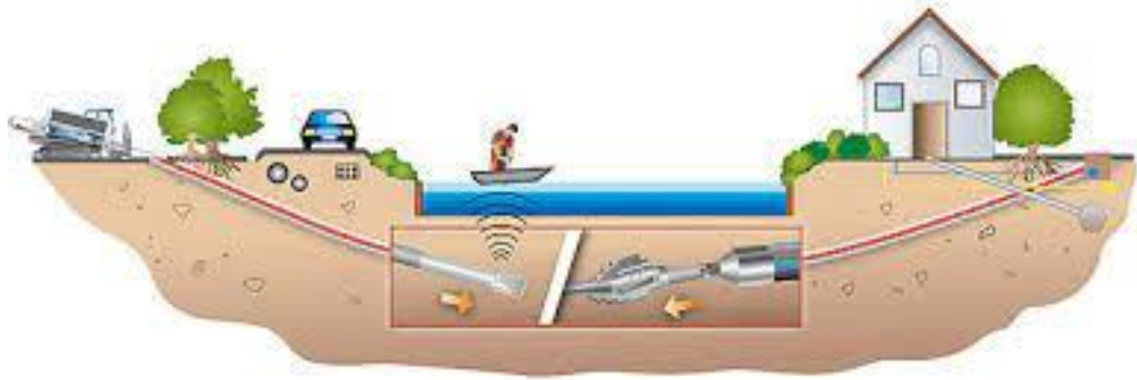
8. ábra: az irányított fúrás
