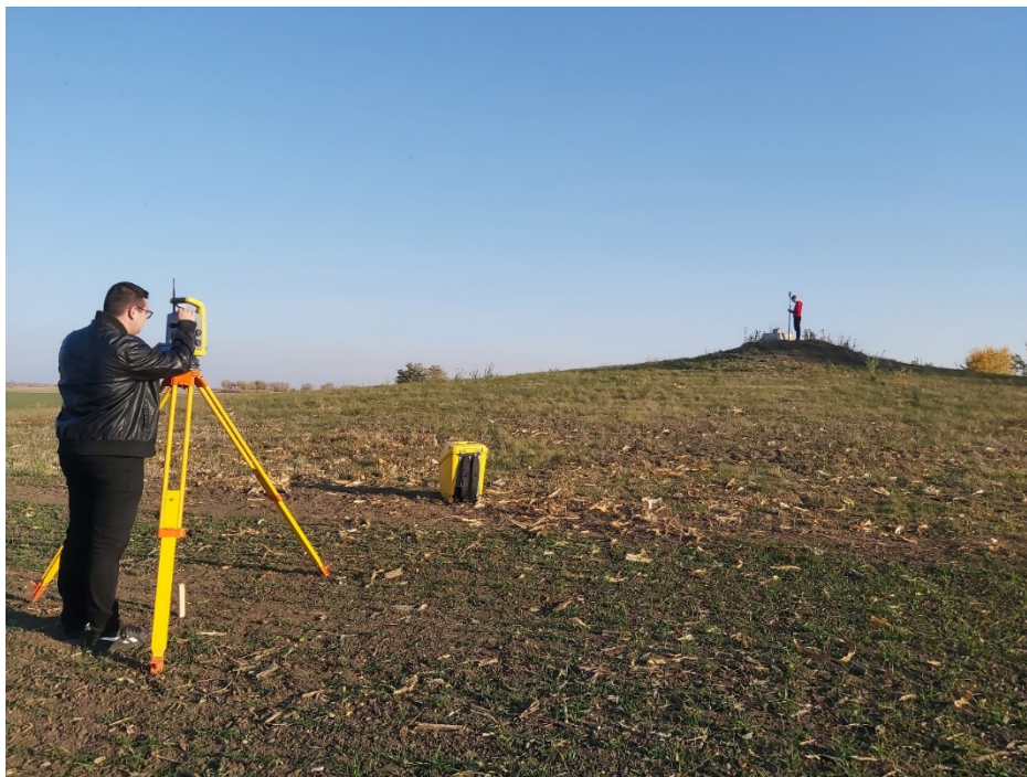
4-6. ábra: Mérőállomással végzett mérés folyamata figuráns segítségével.
