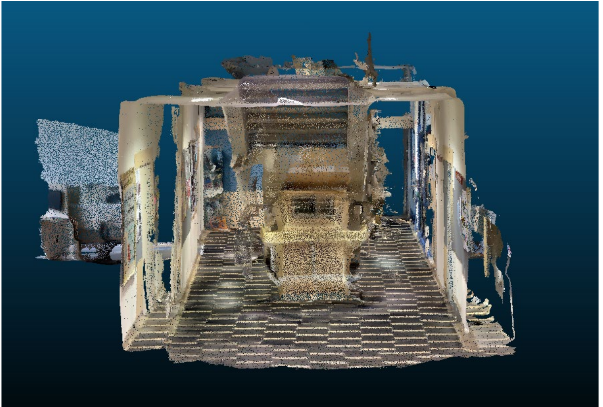
47. ábra: A kihagyásra került felvétel. Kétszeresen képződött le a folyosó fala, valamint a lépcső is igen zavarosan jelent meg. Saját kép
