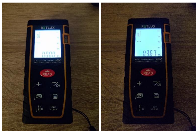
13. ábra: A távolságmérő készenléti üzemmódban
