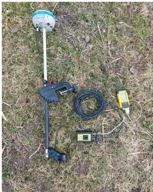
11. ábra: Az általam összeállított rendszer (SonarMite BTX szonár, Stonex S9III plusz GNSS vevő és Getac PS336 kezelő)
