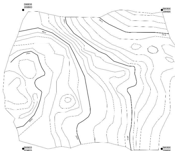
9.ábra: Mérőállomással végzett mérés alapján készült szintvonalrajz (saját kép)
