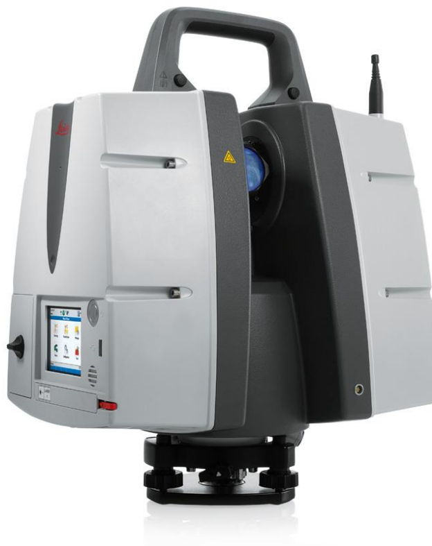
9. ábra: Leica P40 lézerszkenner [21]
