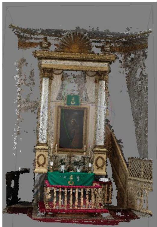
13. ábra: Sűrített pontfelhő, törlés előtt
