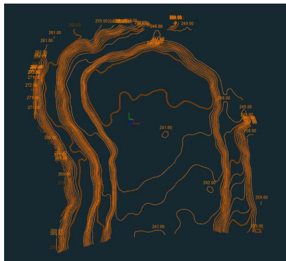
12. ábra Szintvonalak generálása és magasságok megírása
