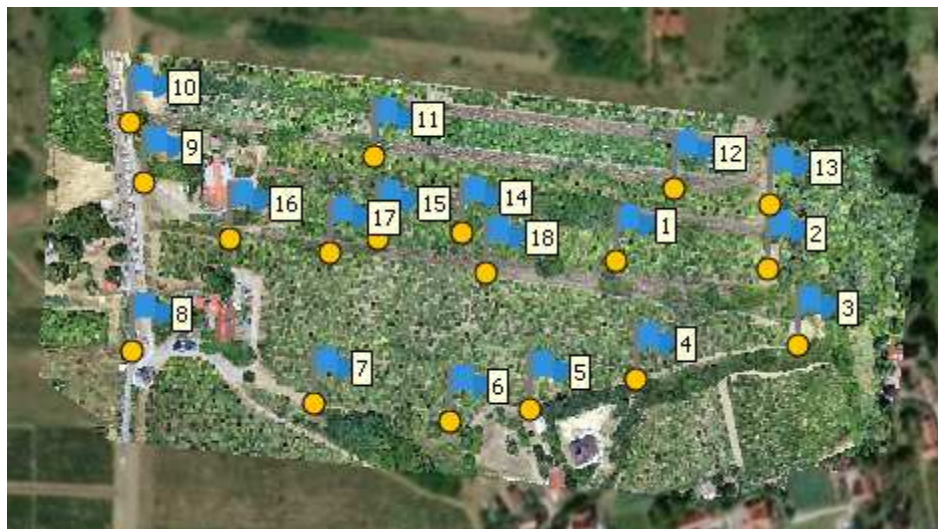
6.11. ábra Illesztőpontok elhelyezkedése a munkaterületen (Forrás: saját kép)
