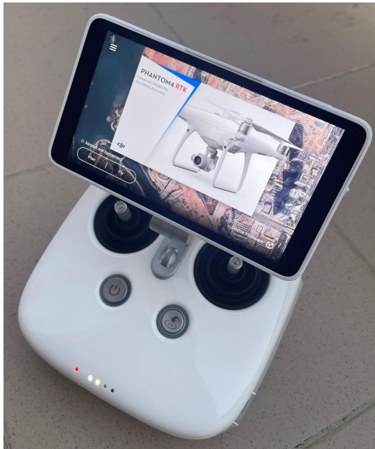
9. ábra: DJI Phantom 4 RTK kontrollere a bekapcsolás után. Első lépésként ki kell választanunk, hogy tervezés vagy repülés módot indítunk-e el.
