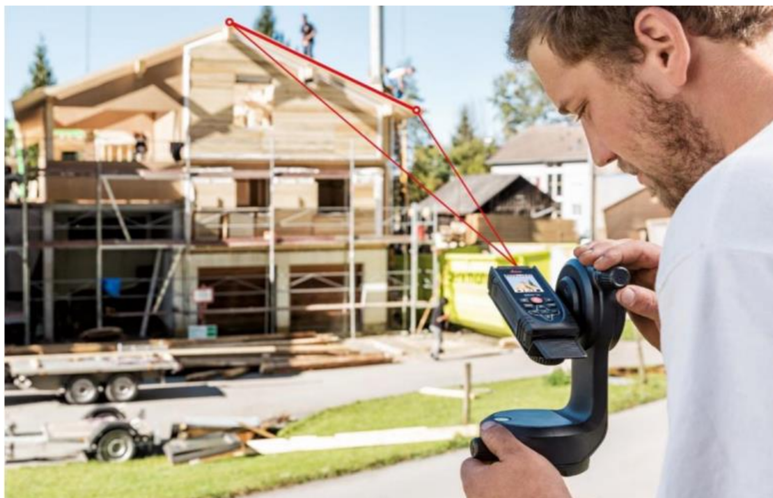
5. ábra: A lézertávmérő mérőállomás módban (4.)
