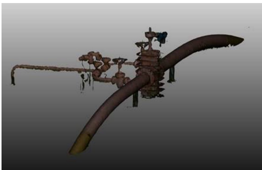
29. ábra Teljesen automatizált eljárással létrehozott csőmodell
