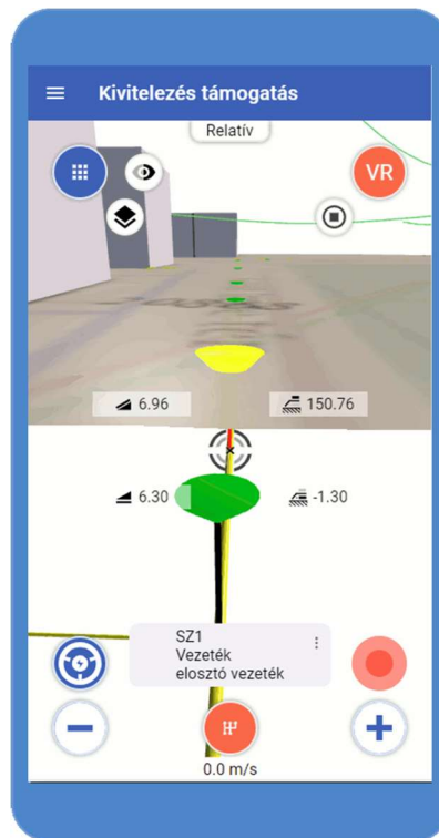
7. ábra: Vizualizációs jelek alkalmazása vezetékvégpontok jelöléséhez
