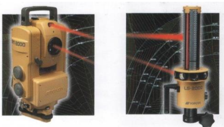
24. ábra Mérőállomás és a detektor 27
