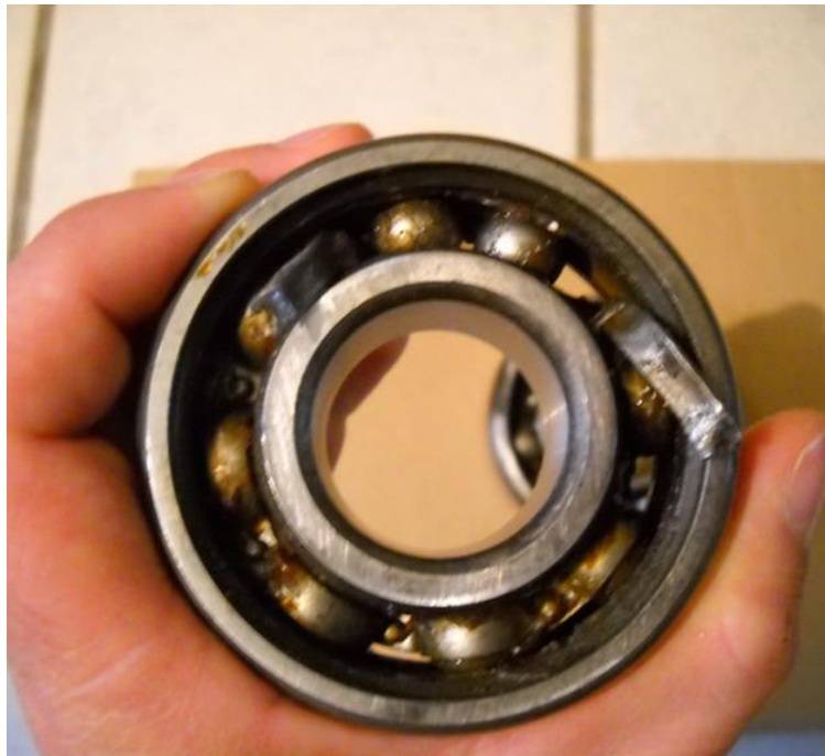
3.3. ábra Csapágykosár-törés, idegen fém bejutása miatt. A kopási határvonal, határterület kigondolásának alapvető indítéka volt az ábrán látható kosár állapota.
