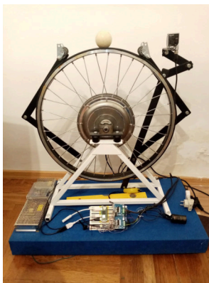
1-1. ábra Golyó a keréken összeállítás
