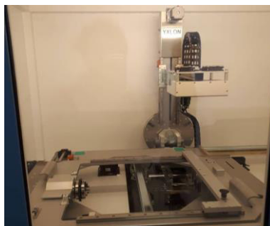
1. ábra Y. Cheetah FXE 160.51 típusú multifókuszú röntgen berendezés, áttekintő kép a berendezésről (balra), vizsgáló kabin (jobbra)
