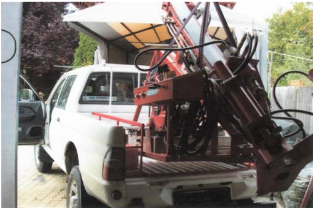
2.ábra: Borro fúrógép (származás: saját kép)
