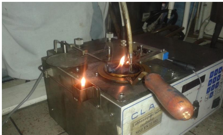
4. kép: Lobbanáspont mérés CLA 2 típusú készülékkel (saját kép)
