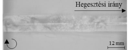
8. mérési pont ( n=1000 1/perc, v_f=200 mm/perc)
