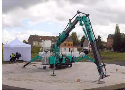
1. ábra - Pókdarura szerelt nyomtató
