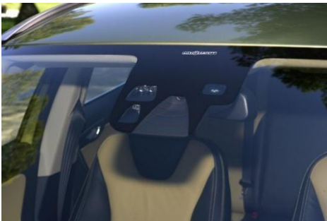
7. ábra balra a City Safety érzékelői [15], jobbra a működését szemléltető ábra [16]
