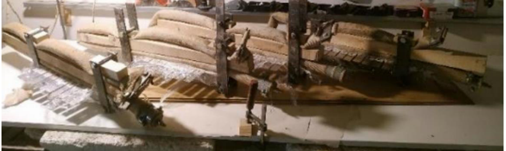
2. ábra Munkadarabok különböző 1, 3 és 6 bar nyomás alatt egyidejűleg
