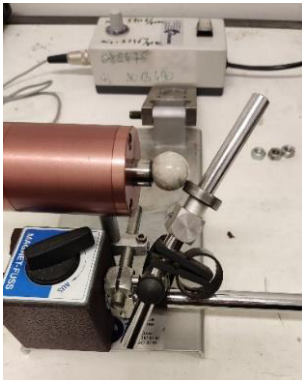
4. ábra Koptató berendezés
