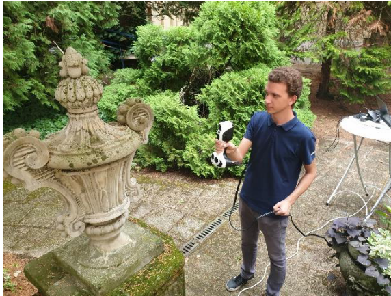
3. ábra. Sérült homlokzati elem szkennelése SCANTECH iReal 2E Color kézi 3D szkennerral
