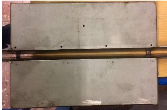
3. ábra Összefűzött próbatest a termoelemeknek előkészített furatokkal
