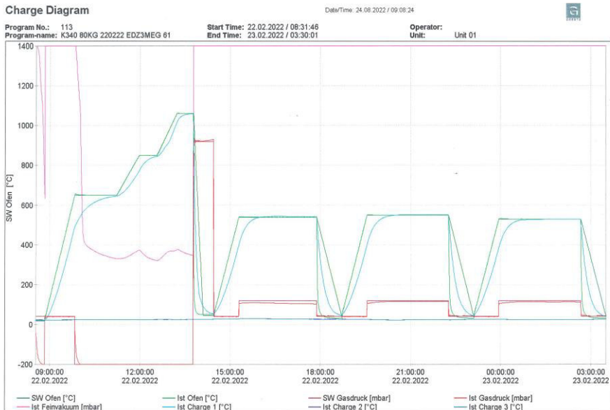
2. ábra A 80kg-os szerszám hőkezelési diagramja
