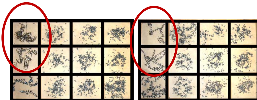
10. ábra MC jelű forgácstörő
