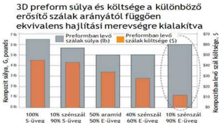
19. ábra: Különböző erősítésű szálak megfelelő arányú alkalmazása
