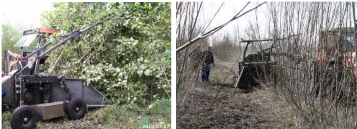
1. kép - 2. kép: A zöldenergiafák kévés betakarítógépe tesztüzemben
