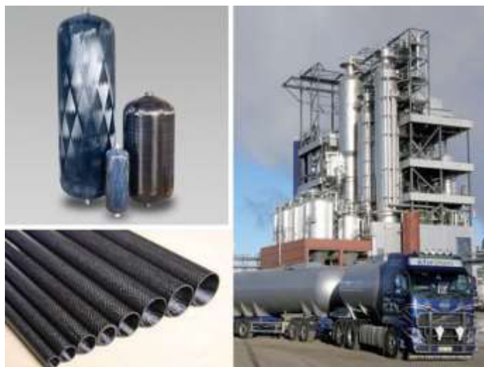
16. ábra: Szállító tartályok és csővezetékek tekerccseléssel való gyártása
