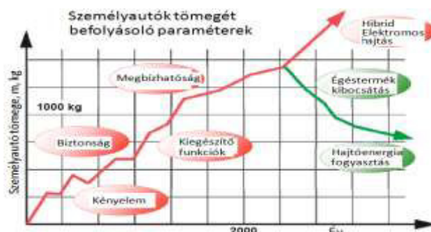
13. ábra: Személyautók tömegének növekedése a vázszerkezet tömegének csökkentésével kompenzálható
