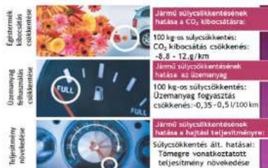
14. ábra: Járművek súlycsökkentésének hatásai
