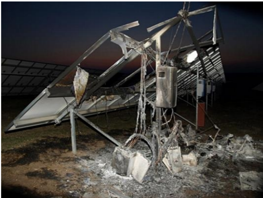
9. ábra: Csehországi napelemes rendszer közvetlen villámcsapást követően (Forrás: https://www.dehn.hu/sites/default/files/media/files/gyik-09.pdf )
