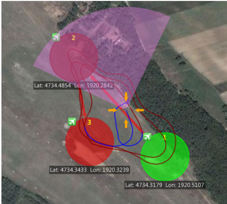
6.14. ábra. StyroWing berepülése (kékkel a manuális, pirossal az autonóm nyomvonal)
