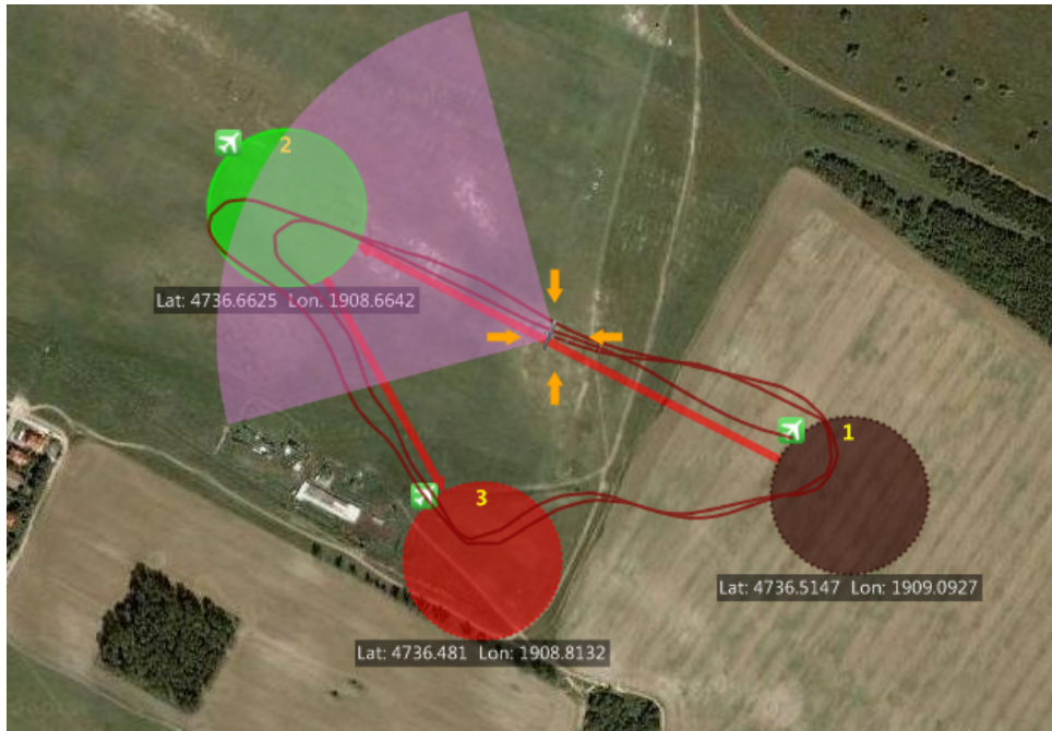
6.9. ábra. Chelidon három fordulópontból álló tervezett és megvalósult autonóm útvonala vektormezős navigációt felhasználva
