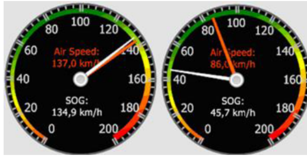
5.1. ábra. Repülés szélcsendes időben és erős szélben [B4]
