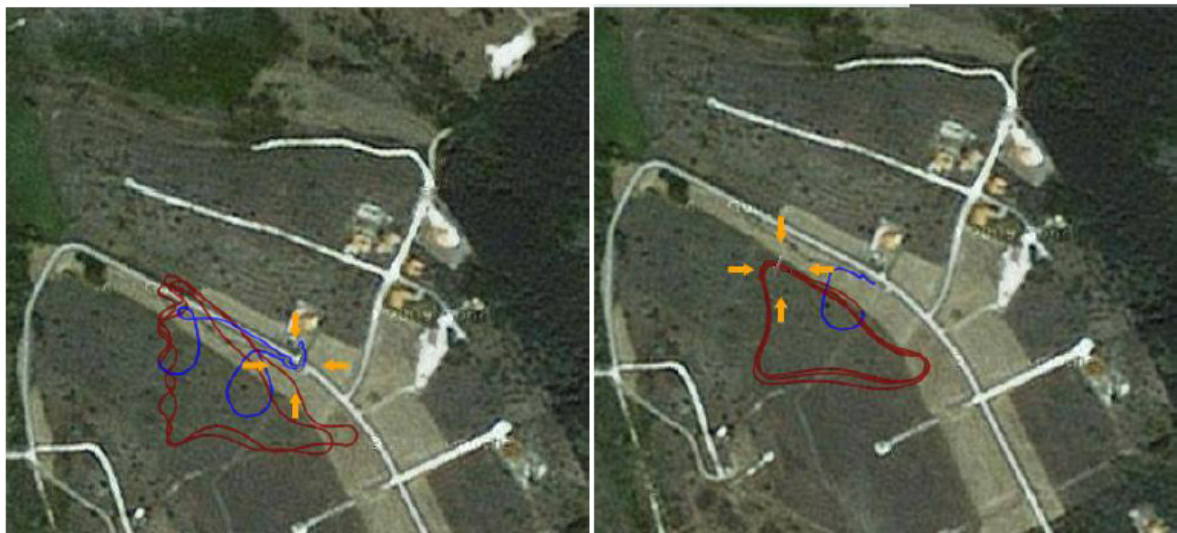
4.10. ábra. Navigáció haladási irány és pozíció becslés nélkül és becsléssel (pirossal az autonóm, késsel a manuális útvonal [B7])
