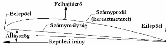
1.1. ábra. Egy tipikus szárnyprofil [6]
