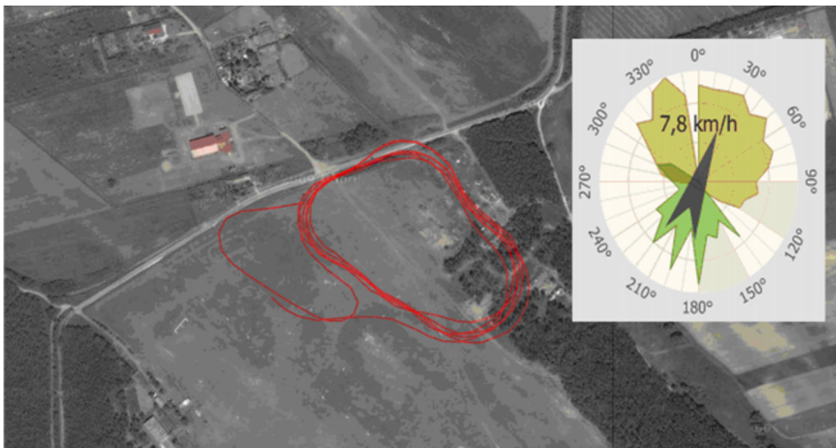
6.2. ábra. Tiger60 stabil útvonalrepülése klasszikus navigációval és harmadfokú nemlineáris szabályozóval[B4]
