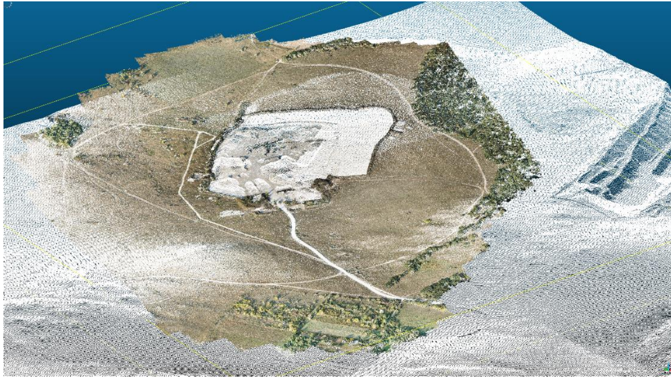
36. ábra: A két pontfelhő illeszkedése az EOVS rendszerben
