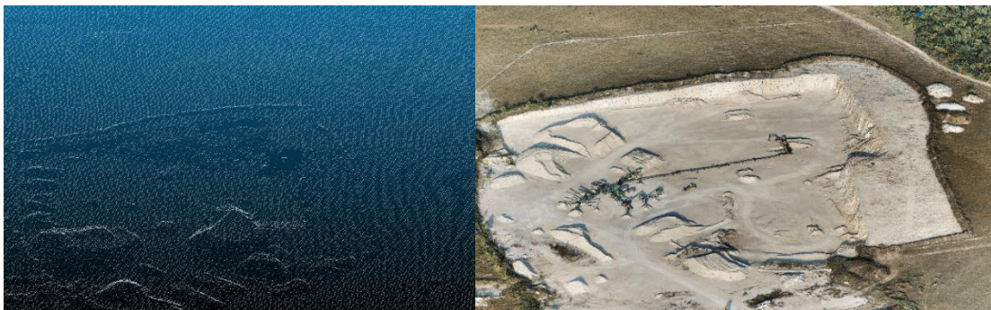
37. ábra: azonos kameraállásból szemlélt UAV és LIDAR pontfelhő
