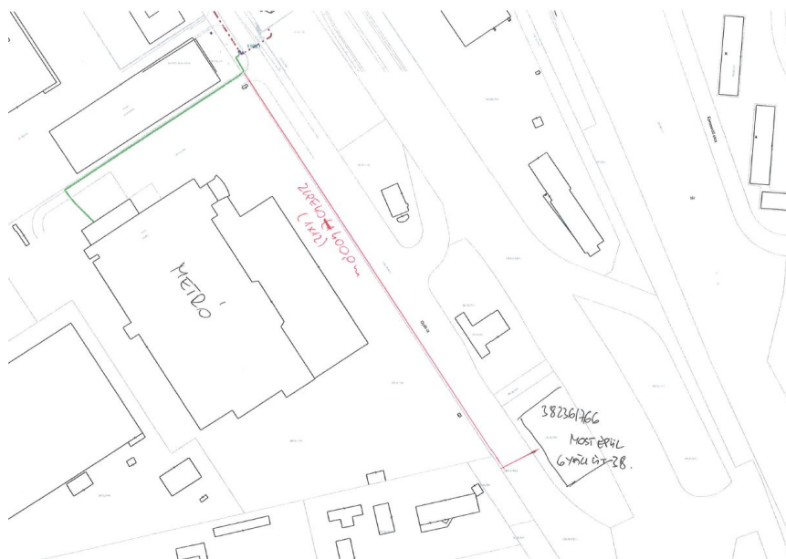
7. Ábra: A megrendelő cégtől kapott terv. Pirossal a tervezett földkábel helye látható.
