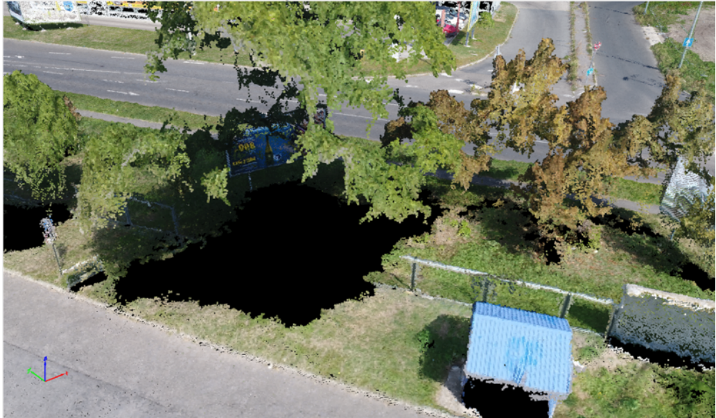
36. Ábra: Jól látható a falomb okozta kitakarás.
