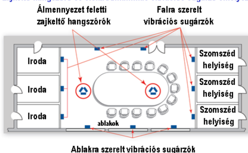
49. ábra: Védett helyiség határoló szerkezeti elemeinek és üregeinek akusztikus zavarása Forrás: [125]
