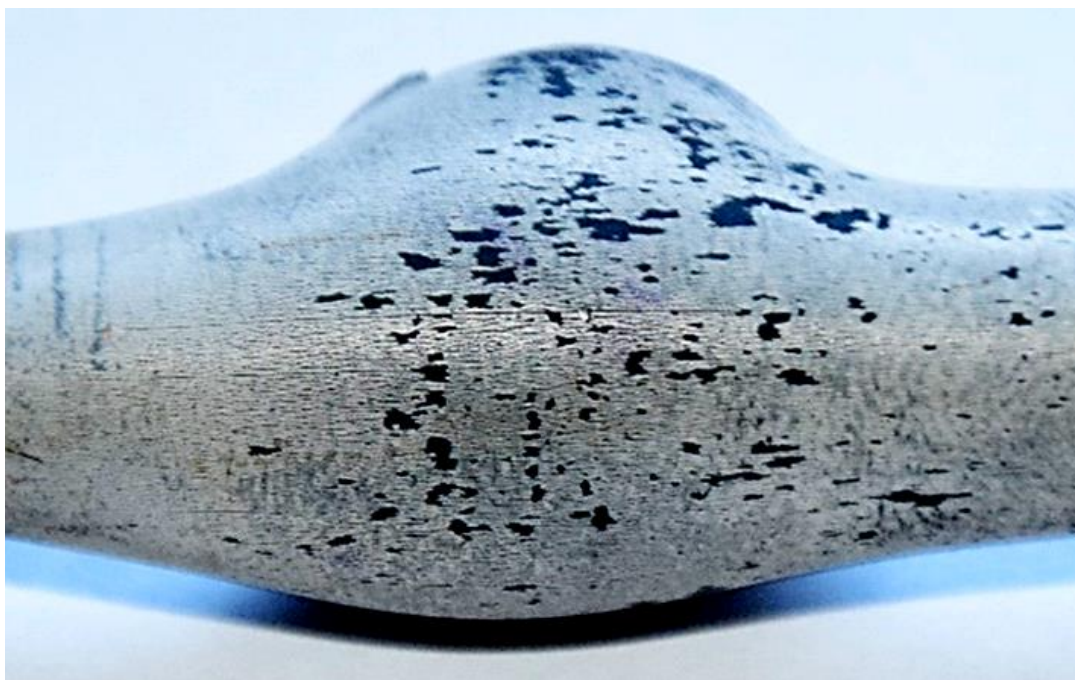
59. ábra. Az 1. számú minta oxidálódott felületén megjelenő barázdák rajzolata.
