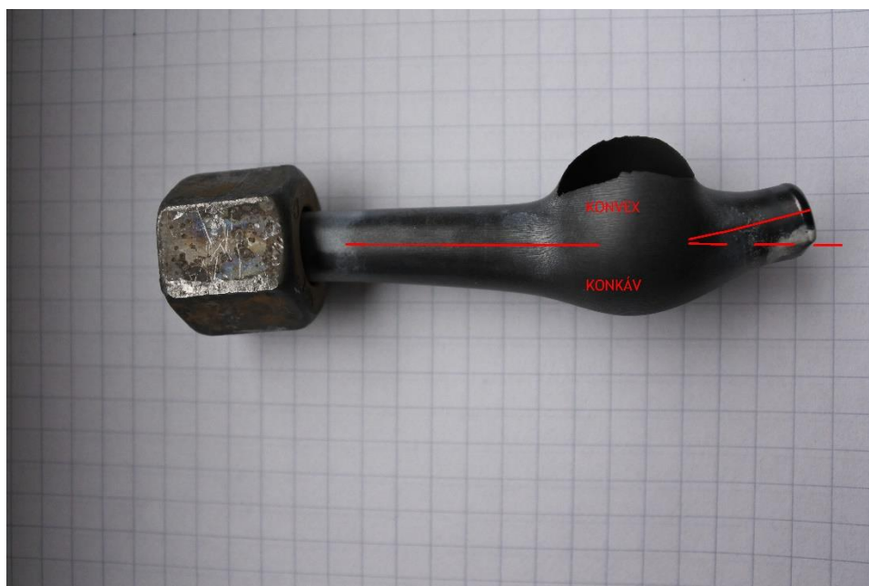
55. ábra A felhasadt minta konvexitásának definíciója.
