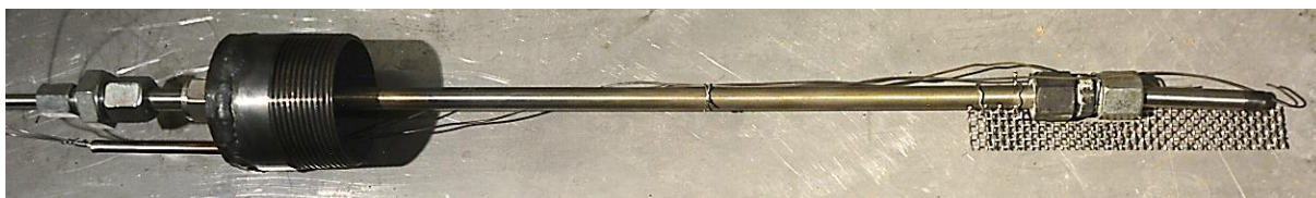
53. ábra. Egy hegesztett cirkónium minta a kemencébe történő behelyezés előtt.
