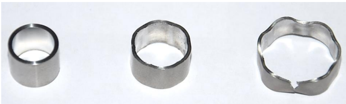
23. ábra. A mandrel szerszám által okozott alakváltozások az első próbamérés alkalmával.
