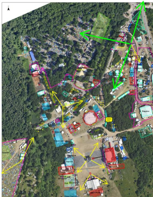
31. ábra Illusztráció egy tömegrendezvényre telepített bázisállomások lehetséges elrendezésére, a szektorok feltüntetésével [Forrás: saját szerkesztés]
