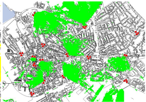
117. Ábra 13-as vivő leosztása és azon cellák cellahatárai (bal oldalt) [Forrás: saját szerkesztés]
