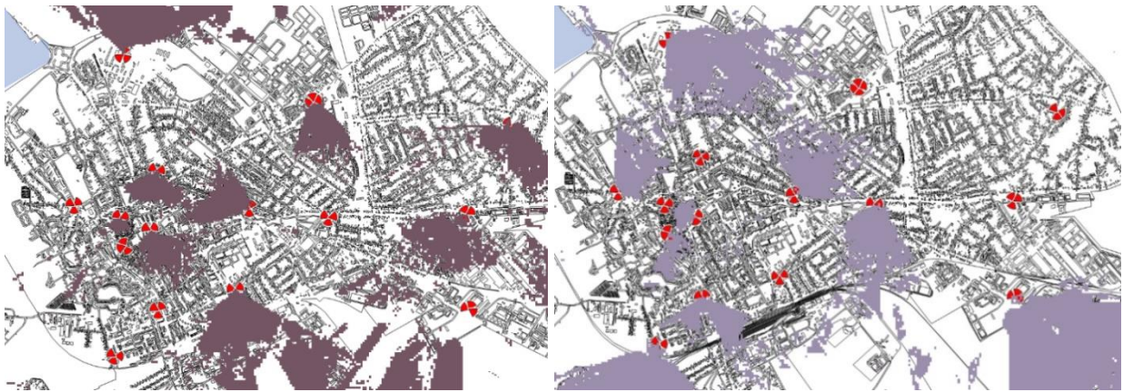
127. Ábra 23-as vivő leosztása és azon cellák cellahatárai (bal oldalt) [Forrás: saját szerkesztés]
