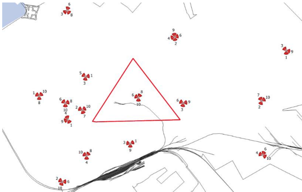
14. ábra A vészhelyzeti állomás BCCH frekvenciaterve [Forrás: saját szerkesztés]
