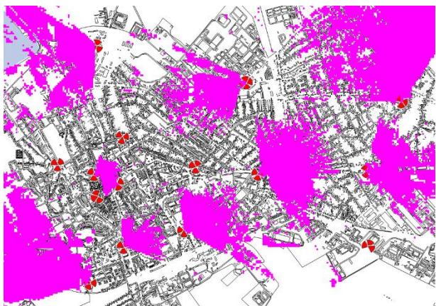
119. Ábra 15-ös vivő leosztása és azon cellák cellahatárai (bal oldalt) [Forrás: saját szerkesztés]
