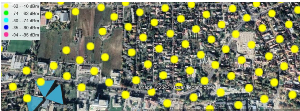
49. ábra GSM 900 jelszintmérés eredménye [Forrás: mérési eredmény]
