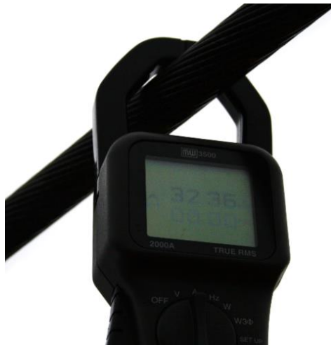
36. ábra. A méréshez használt MW 3500 típusú lakatfogó
