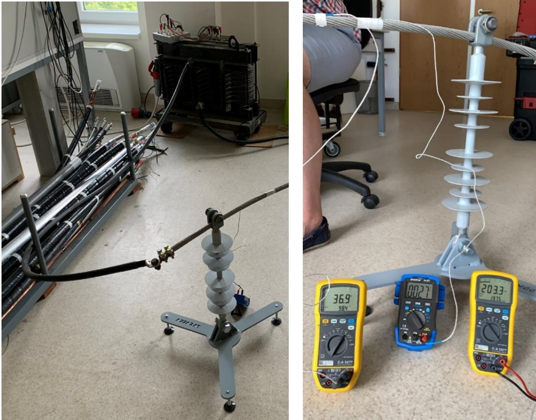
91. ábra. A sodrony megtáplálása és a hőmérséklet érzékelők
