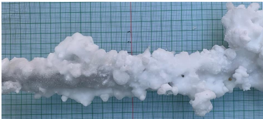
90. ábra. Jeges sodronyok a kísérletben [45]
