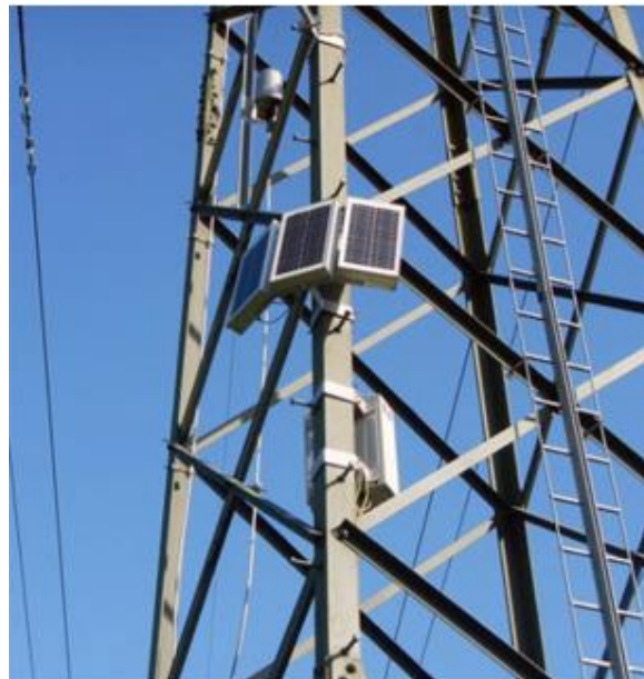
101. ábra. Távvezetési oszlopra szerelt OTLM meteorológiai állomás [68]
