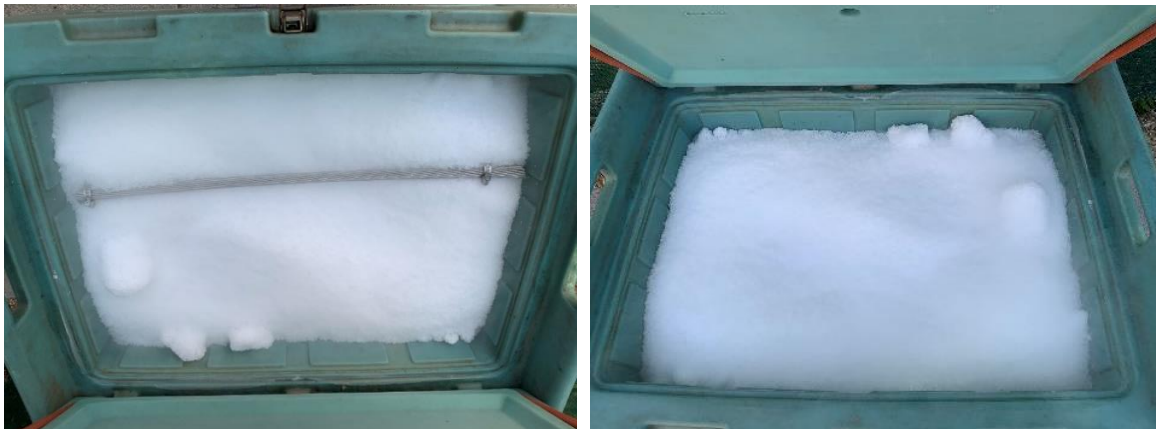
88. ábra. Hőszigetelt tároló láda sodronnyal és szárazjéggel
