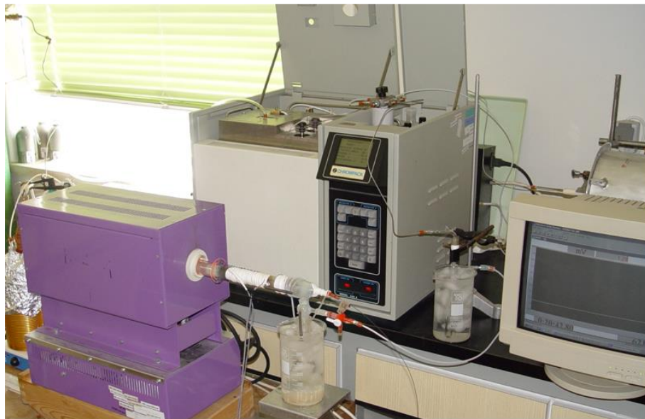
14. ábra: A breakaway oxidáció tanulmányozásához összeállított kísérleti berendezés (balról jobbra: gőzfejlesztő, csökemence, kondenzátorok, TCD detektor, adatgyűjtő rendszer)
