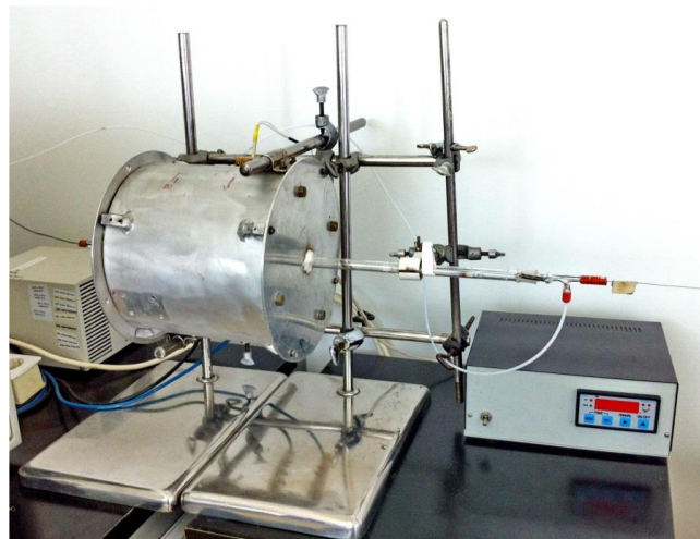
16. ábra: Szabályozó egységgel ellátott csőkemence a cirkónium mintákban elnyelődött hidrogén mennyiségének meghatározásához
