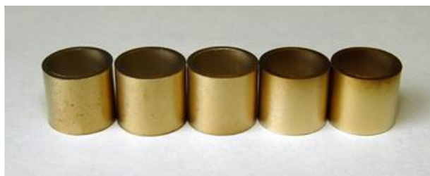
55. ábra: Tiszta nitrogénben 1000 °C-on, különböző ideig (390, 690, 1200, 1800, 3600 s) hőkezelt E110 minták fényképe (balról jobbra)
