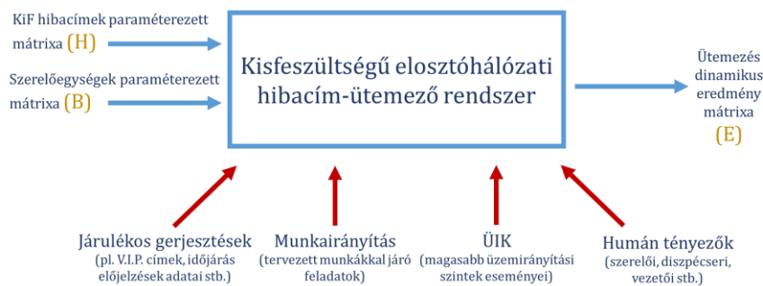
9. ábra A javasolt kisfeszültségű hibacím-ütemező-rendszer (LFS) egyszerűsített matematikai modellje [10]
