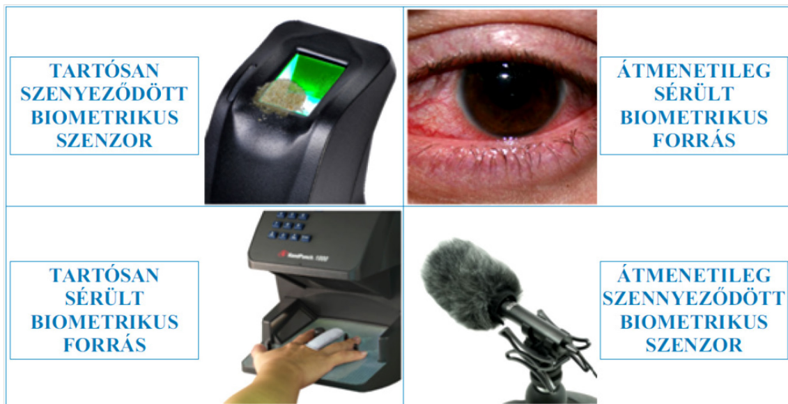
3. ábra: Példák biometrikus azonosítási módszerek hibaforrásaira
